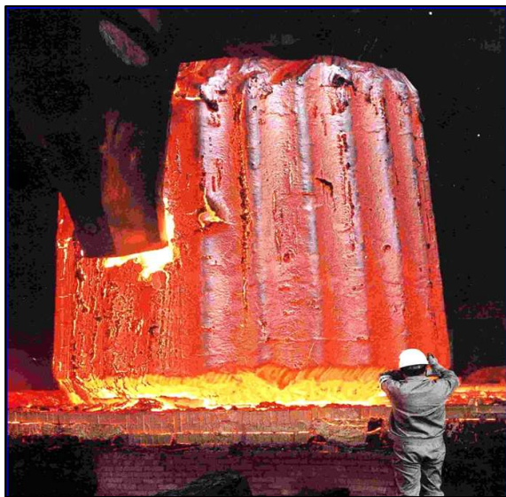
超大型鋼塊の製造
